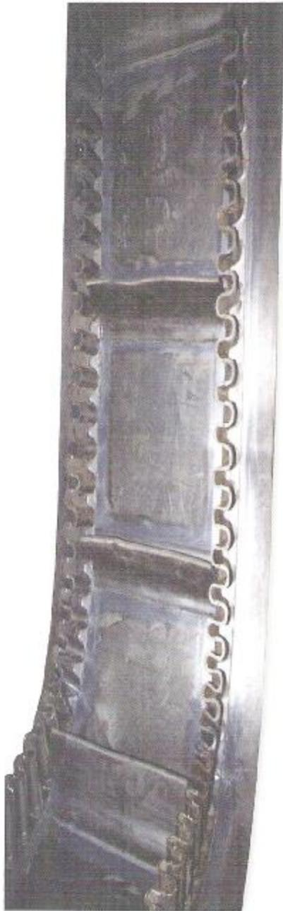
Nastri trasportatori a più tele con coperture specificatamente adatte a vari trasporti con bordi di contenimento laterali e traverse a tazza in grado di permetterne il sollevamento su pendenze fino a 80° ed oltre su percorsi a inclinazione variabile con portate considerevoli.
