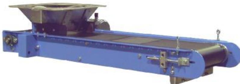
Quando si rende necessaria l'installazione di dosatori in impianti esistenti o dove lo spazio è ridotto, il nastro a fianco è l'ideale: ingombri piccolissimi, una piccola tramoggia inox con regolazione della vena e un'unica cella centrale che può essere appesa a una qualsiasi parte rigida dell'impianto, sono le caratteristiche che contraddistinguono questa serie di nastri.
