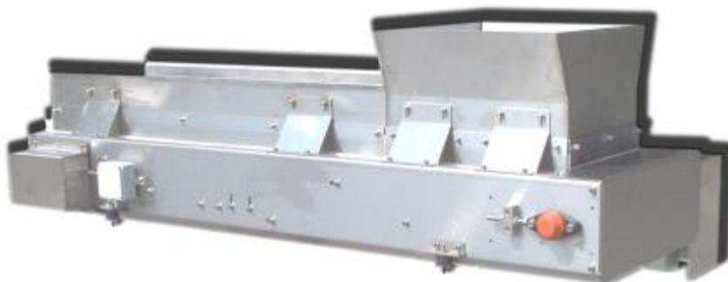
La versione a fianco, completamente in acciaio inox e con componenti elettronici IP67, permette il lavaggio del nastro a getto d'acqua ed il suo utilizzo nell'industria alimentare per **frutta sfusa, coloranti, aromi**.
